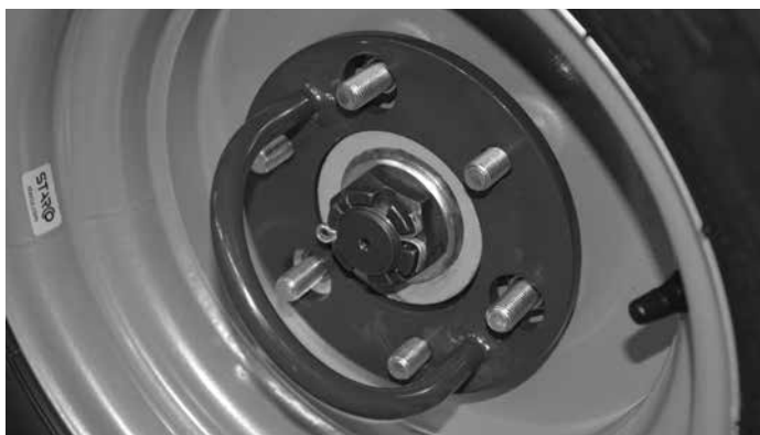
Nedre beslag på hjulnav A423161.
