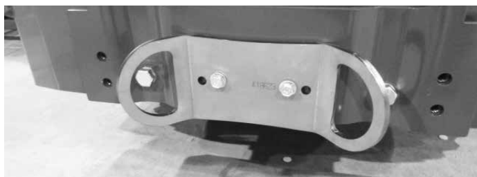
Nedre beslag A418623 monteret på bagerste kofanger eller modvægt
